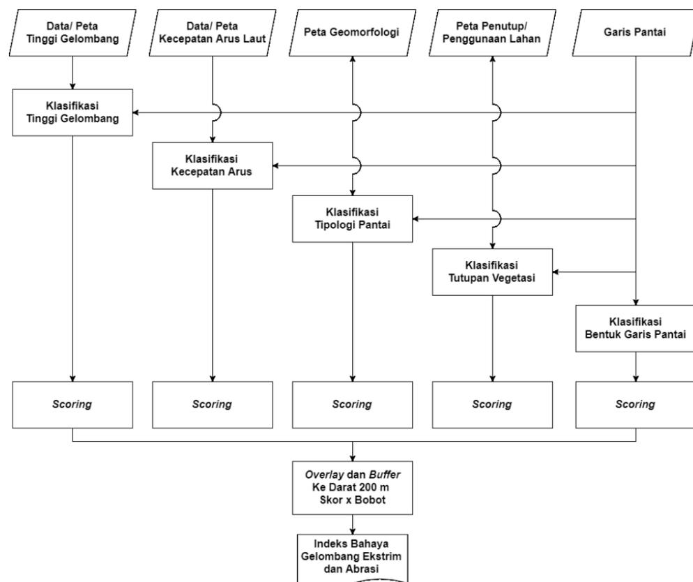
Gambar 3.6. Diagram Alir Pembuatan Peta Bahaya Gelombang Ekstrim dan Abrasi
